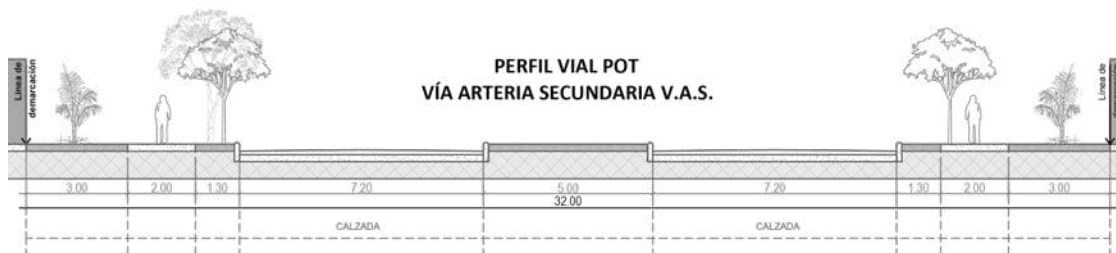
Ilustración 14. Dimensiones reglamentadas para Vía Arteria Secundaria V.A.S. en el POT. Elaboración área normativa UD. Fecha elaboración: 04/11/2016 con base al POT 2.000, Plano No. 05 PLAN VIAL GENERAL PROPUESTO - URBANO. Fecha elaboración: 2016/11/01
