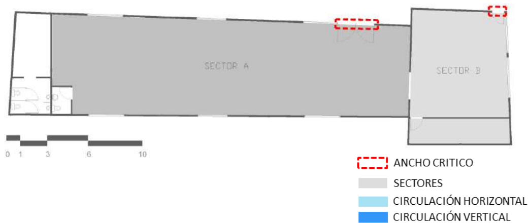
Ilustración 198 condiciones de circulación del bloque Fuente: equipo diagnóstico
