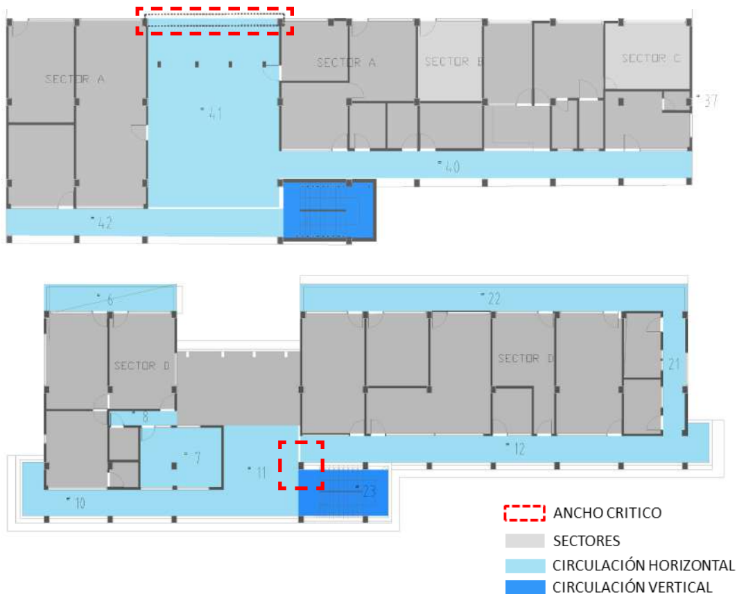
Ilustración 16 condiciones de circulación del bloque Fuente: equipo diagnóstico
