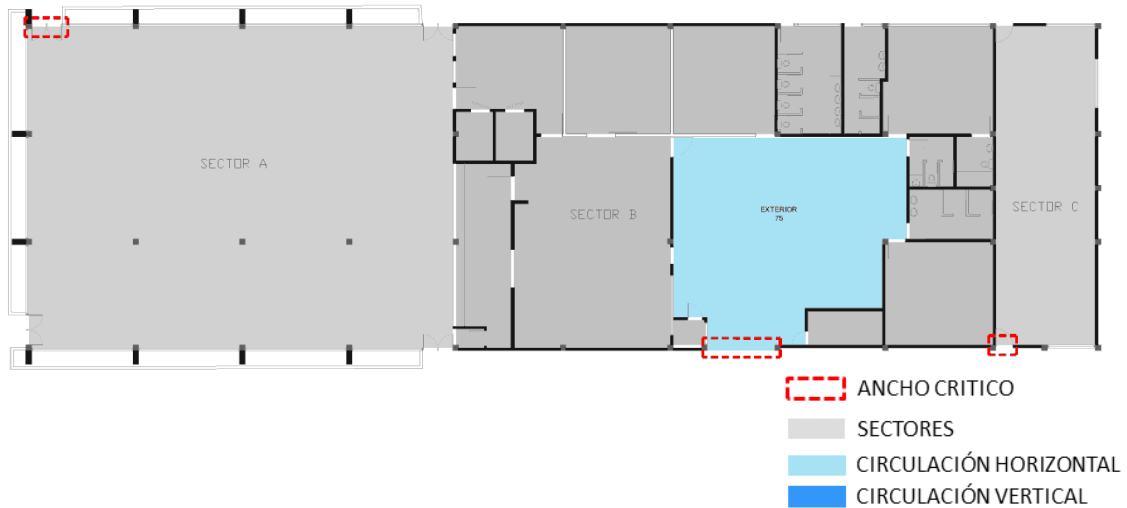
Ilustración 36 condiciones de circulación del bloque. Fuente: equipo diagnóstico.
