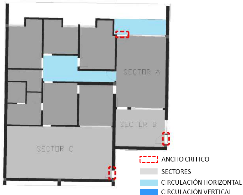
Ilustración 58 condiciones de circulación del bloque Fuente: equipo diagnóstico
