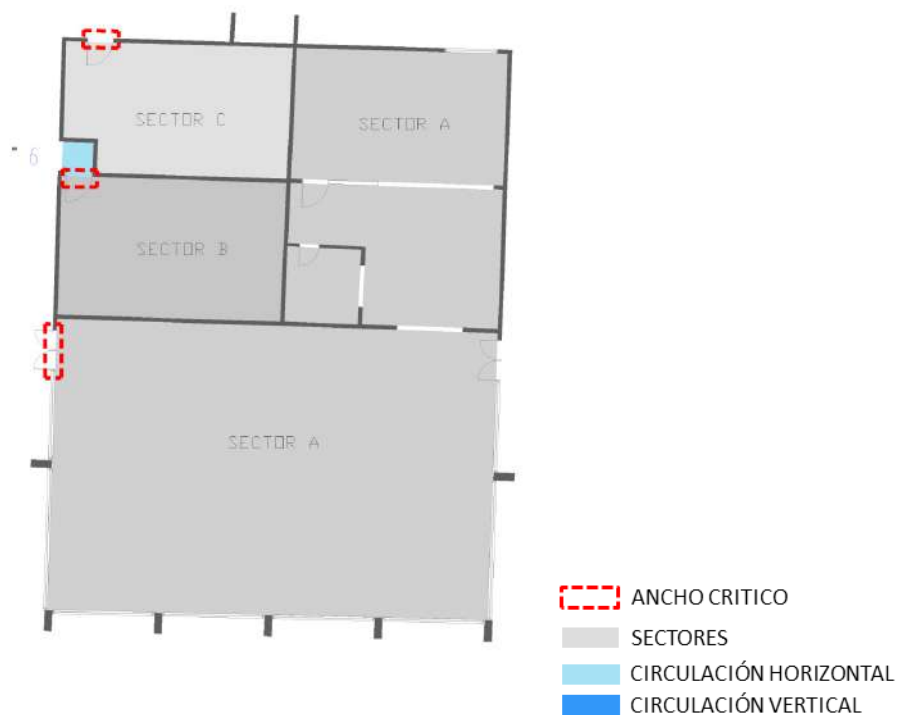
Ilustración 74 condiciones de circulación del bloque Fuente: equipo diagnóstico
