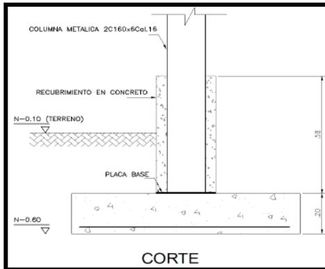
CUENTA CON UNOS PERNOS Y PLATINA DE ANCLAJE NO DEFINIDOS Y UN RECUBRIMIENTO EN CONCRETO QUE NO SE ENCUENTRA EN UN BUEN ESTADO, LO CUAL NO CUMPLE CON LA FUNCIÓN DE AISLAR EL AGUA DEL PERFIL, EL CUAL ESTA LOGRANDO QUE LA ESTRUCTURA SE DETERIORE DE FORMA RÁPIDA.
