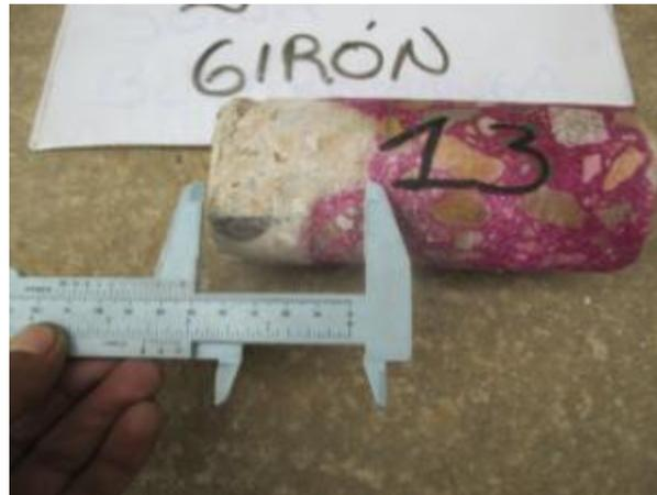
Foto 17 Cilindro de concreto #13, Presencia de carbonatación.
