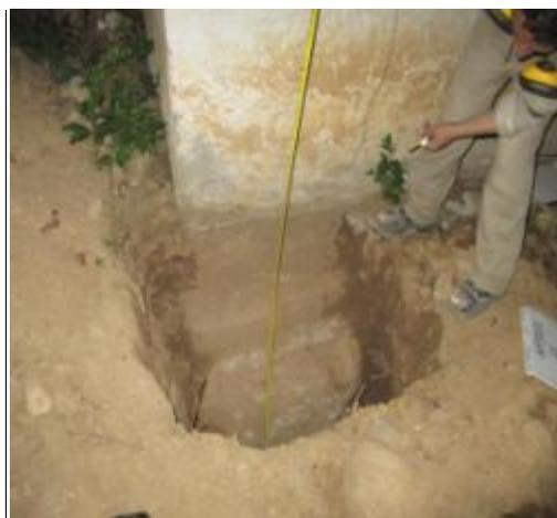
Foto 11 Estructura 9 - Tanque. Piso 1, Apique 8.
