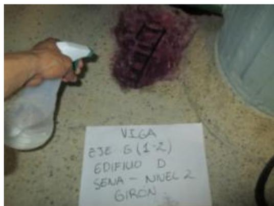
Foto 6 Estructura 2. piso 2, Viga G(1-2) Regata y carbonatación.
