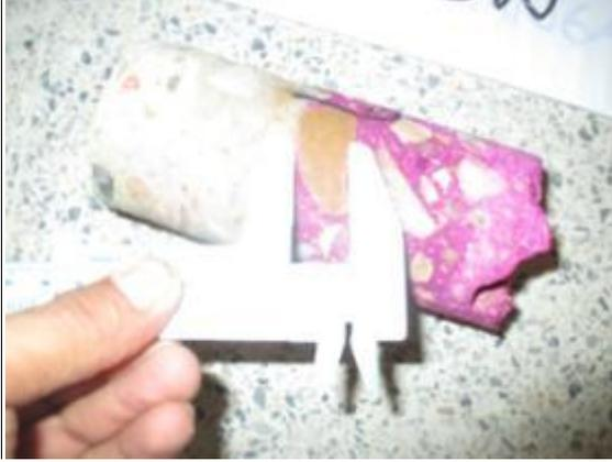
Foto 15 Cilindro de concreto #3, presencia de sobre tamaños, mala gradación, Carbonatación.
