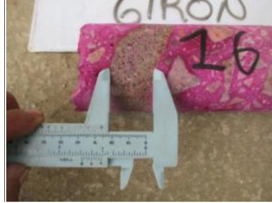
Foto 16 Cilindro de concreto #16, presencia de sobre tamaños, mala gradación.
