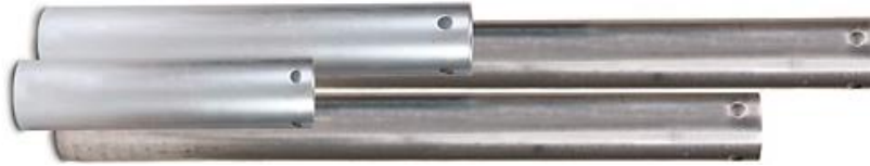
Fotografía 3. Accesorios para la realización de toma de muestras inalteradas tipo tubo de pared delgada Shelby.
