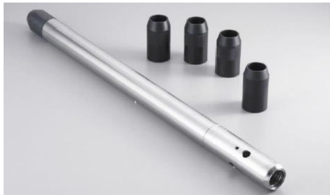
Fotografía 2. Accesorios para la realización del ensayo de penetración estándar (SPT).
