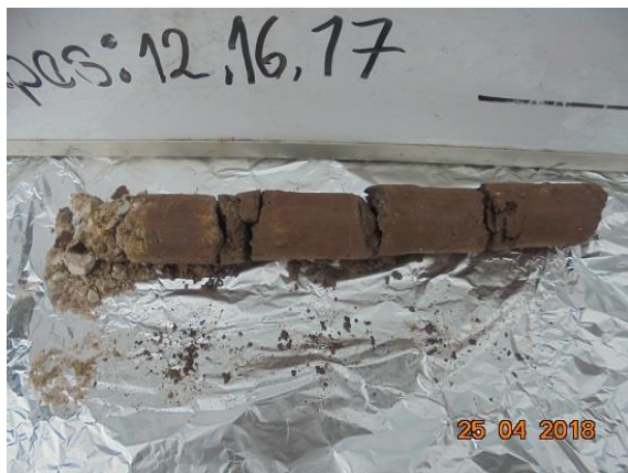
Fotografía 4 Suelo Residual - Formación Bogotá
