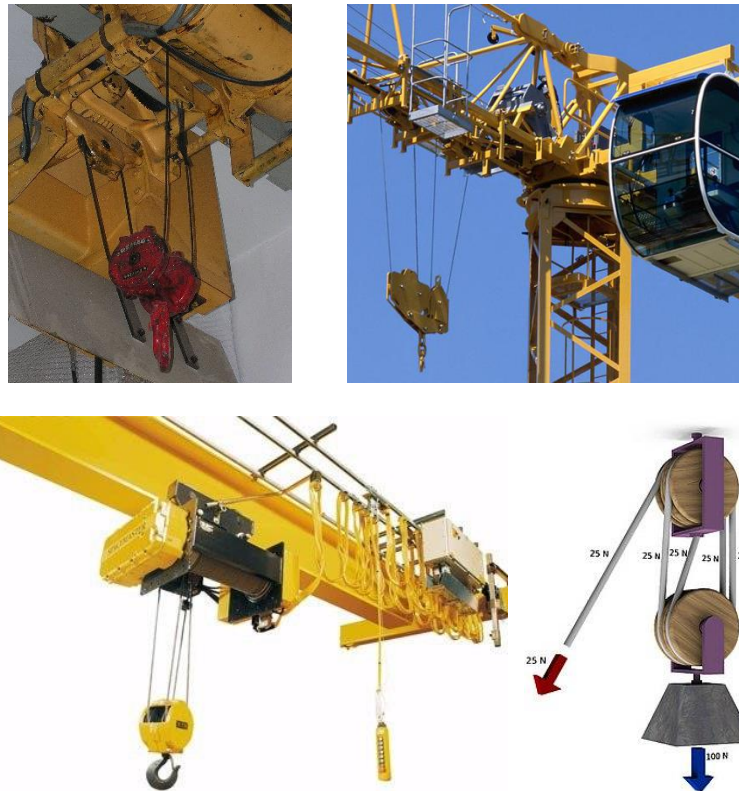
Imagen N° 9. Polipasto de cuatro ramales, ventaja mecánica 4:1.
