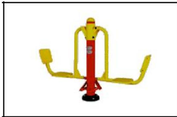
Equipos realizados en Acero con una columna principal de 140mm y un grosor de pared de 3mm. Fabricados con la técnica de fundición por chorro de arena que previene la oxidación de los aparatos. Recubrimiento de 120 micrones anti-corrosión.
