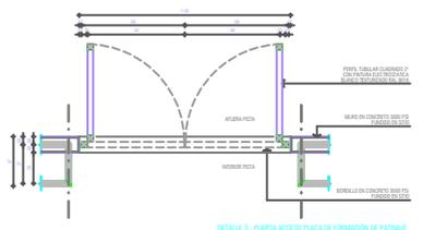
DETALLE 3 - PUERTA ACCESO PLACA DE FORMACION DE PATILLA ALZADO VIVIENDA ECG 1\_20
