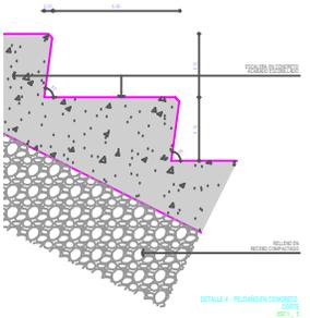
DETALLE 4 - PELDAÑO EN CONCRETO ALZADO VIVIENDA ECG 1\_20
