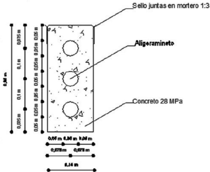
Todo bordillo ha de recibirse en un solado de hormigón hidráulico , clave para su funcionamiento general. Aunque aún pueden verse en ocasiones bordillos ejecutados sin solado, es imprescindible su realización en todos los casos, independientemente del tipo de firmes que delimiten.
