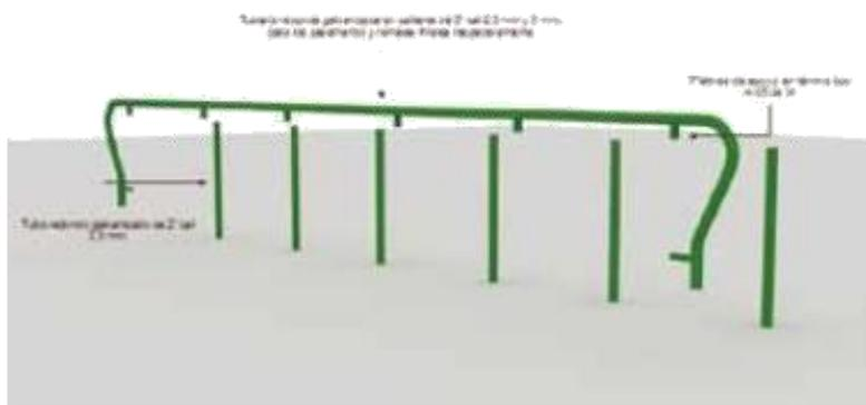
Elemento metálico elaborado en tubería redonda estructural, galvanizada en caliente, con diámetro nominal de 3" cal 2.5 mm y en cal 3 mm, para los remates curvados llamados corbatines. Los parales estarán distanciados cada 1000 mm entre centros y serán fabricados, en tubo redondo galvanizado de 2" nominal cal 2.5 mm.
