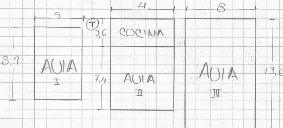
\* AUIA III Cubierta en teja de zinc. estructura en madera Columnas en material Piso AFINADO (MAI estado).
