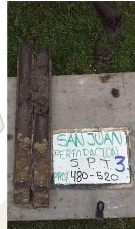
Fotografías 9 a 11. Exploraciones de campo y estratigrafía Perforación P-3
