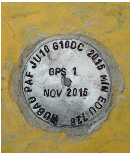
Fotografías 1.1 Instalación de referencias de georeferenciación
