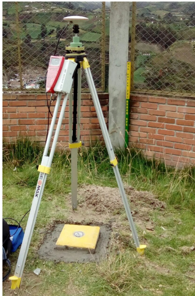
Fotografías 1.1 Instalación de referencias de georeferenciación
