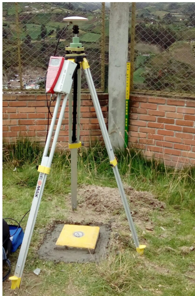
Fotografías 1.1 Instalación de referencias de georeferenciación
