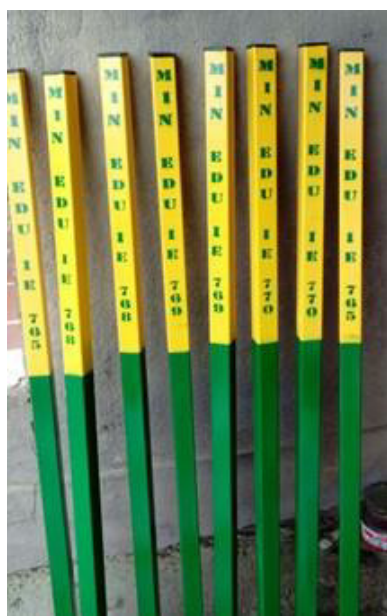
Fotografías 1.1 Instalación de referencias de georeferenciación b) Levantamiento topográfico
