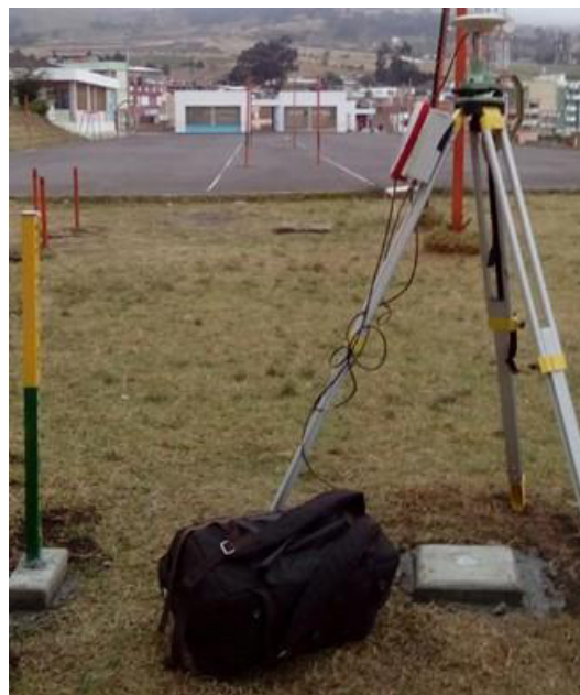
Fotografías 1.1 Instalación de referencias de georeferenciación b) Levantamiento topográfico
