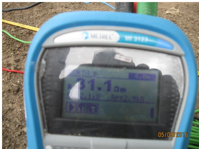
Fig. 4.1 Medición de resistividad del terreno.
