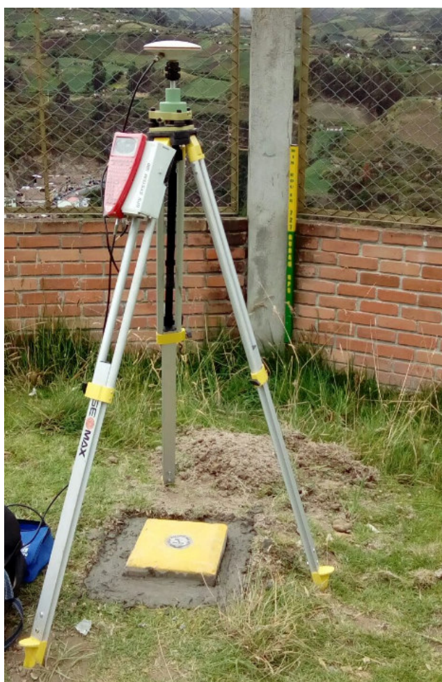
Fotografías 1.1 Instalación de referencias de georeferenciación
