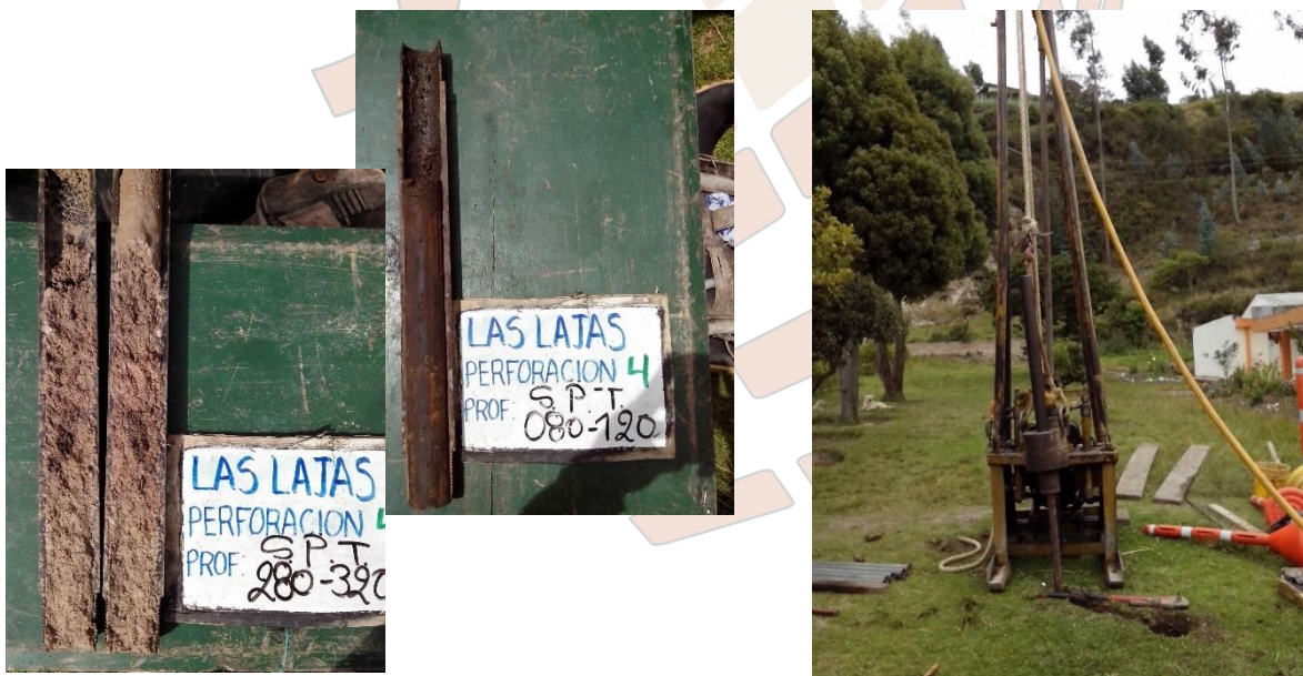
Fotografías 12 a 14. Exploraciones de campo y estratigrafía Perforación P-4
