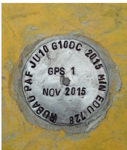
Fotografías 1.1 Instalación de referencias de georeferenciación
