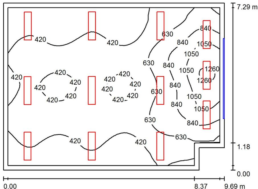
Altura del local: 3.360 m, Altura de montaje: 2.570 m, Factor mantenimiento: 0.80
