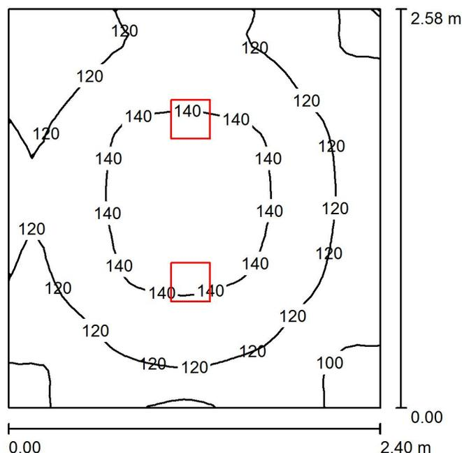
Altura del local: 3.360 m, Altura de montaje: 3.360 m, Factor mantenimiento: 0.80
