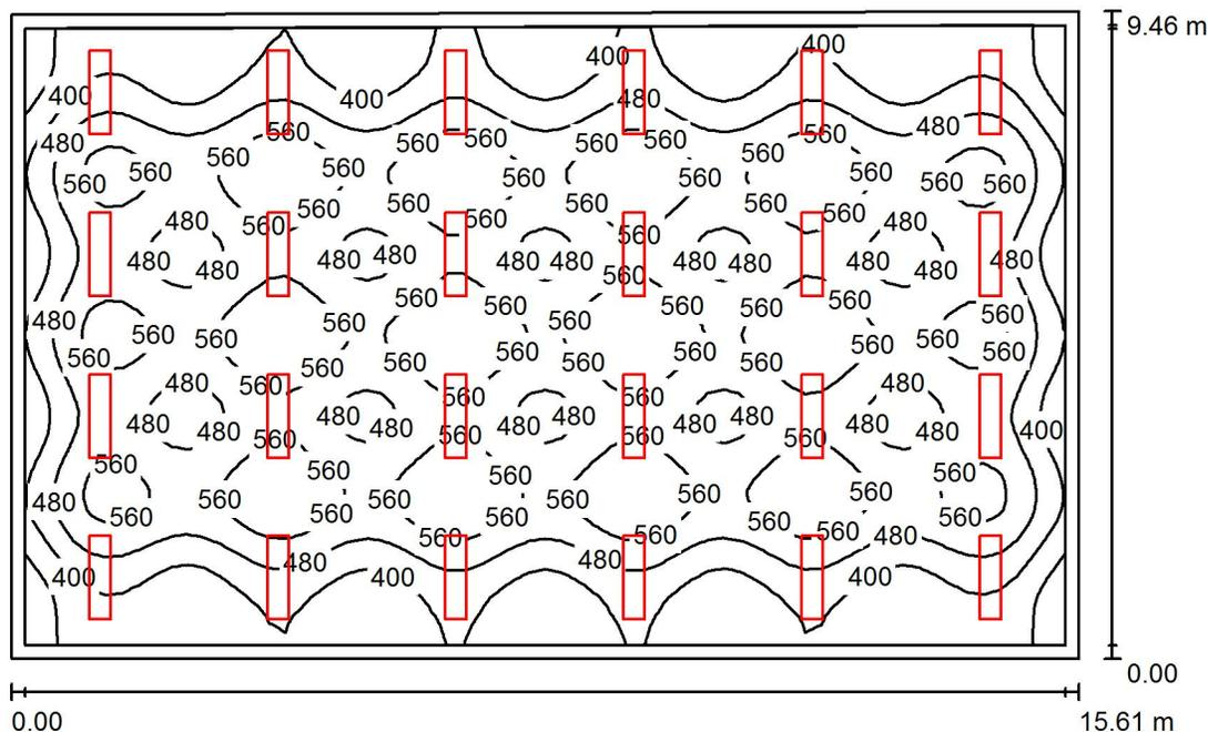
Altura del local: 3.360 m, Altura de montaje: 2.570 m, Factor mantenimiento: 0.80
