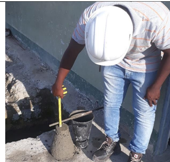
Foto 21: ensayo de Slum
