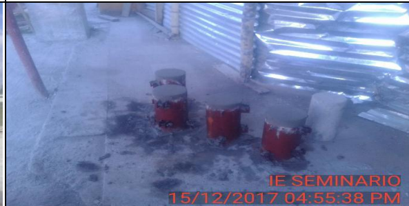
FOTO 15: Toma de cilindros para columnas.
