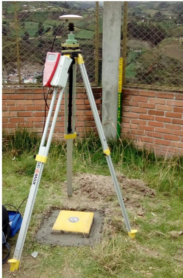
*Fotografías 1.1 Instalación de referencias de georeferenciación*
