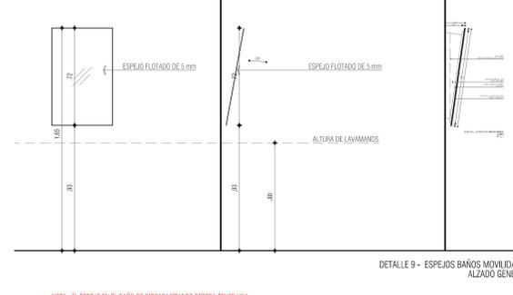
NOTA: CUANDO LOS ESPEJOS TENGAN UN LARGO MENOR DE 40 cm, DEBERÁN ESTAR INCLINADOS 10°. LA ALTAURA DEL INICIO Y DEL ESPEJO, DEPENDERÁ DEL FORMATO UTILIZADO EN LA CONSTRUCCIÓN, CORRESPONDIENDO CON LA ALTAURA DE LAS HILADAS DEL ENCHAZE.
