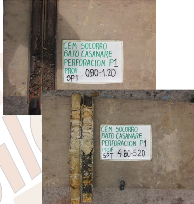
Fotografías 3 a 5. Exploraciones de campo y estratigrafía Perforación P-1
