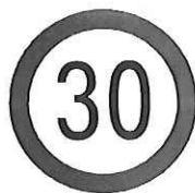
Figura 5. SEÑAL REGLAMENTARIA SR-30 (VELOCIDAD MÁXIMA 30 KPH)
