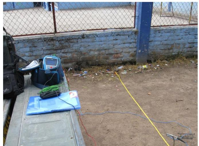
*Fig. 4.1 Medición de resistividad del terreno.*
