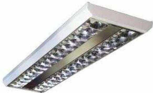
Luminaria fabricada con lámina Cold Rolled en calibre 22, con pintura Poliéstérica color blanco libre de amarillamiento con adaptación para mantenimiento interno. Posee una rejilla semiespeclar de 2x16 celdas de 2" y socket T5 en policarbonato.
