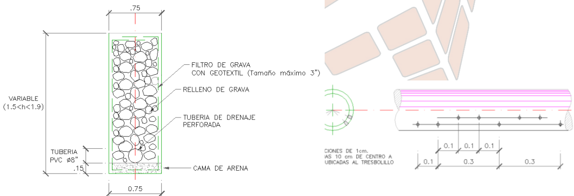
Figura 14. Tipología Filtro perimetral.
