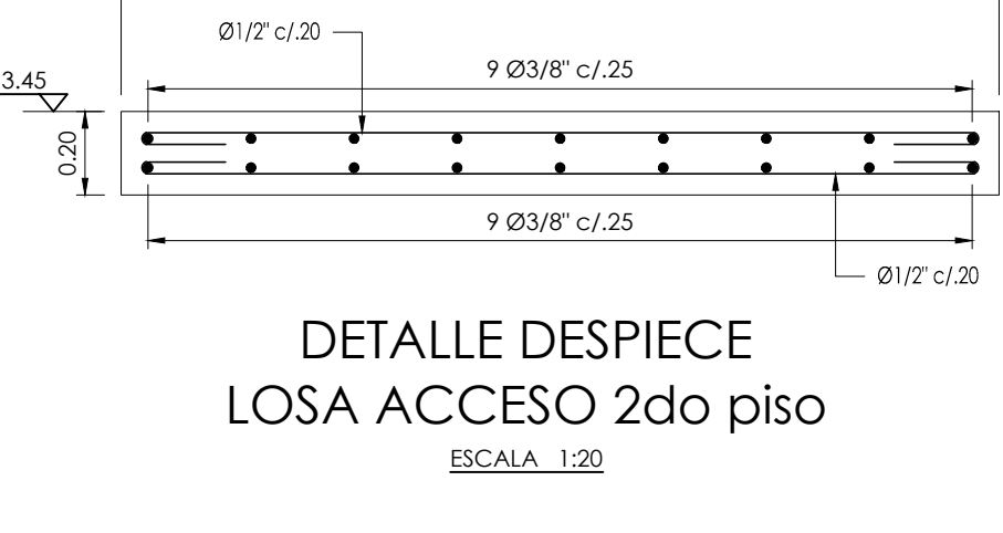
DETALLE DESPIECE LOSA ACCESO 2do piso ESCALA: 1/20
