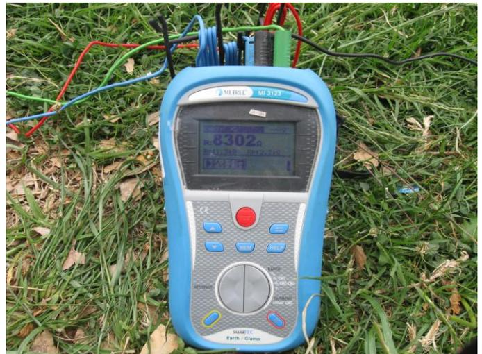
Fig. 5.2 Medición resistencia de puesta a tierra
