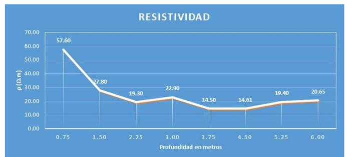
Fig. 4.2 Medición de resistividad del terreno
