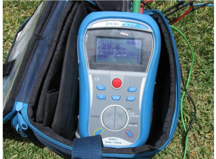
Fig. 4.1 Medición de resistividad del terreno.
