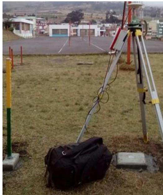
*Fotografías 1.1 Instalación de referencias de georeferenciación*
