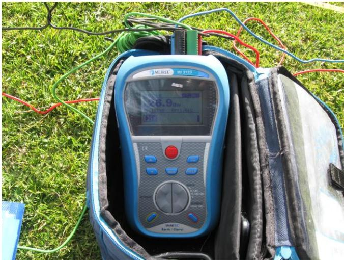
Fig. 4.1 Medición de resistividad del terreno.
