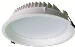
Luminaria tipo Bala LED recesada con driver independiente. Montaje de incrustar en cielo raso, con clip de fijación. Proyección uniforme de la luz con bajo deslumbramiento, reduce los costos de consumo de energía y de mantenimiento.
