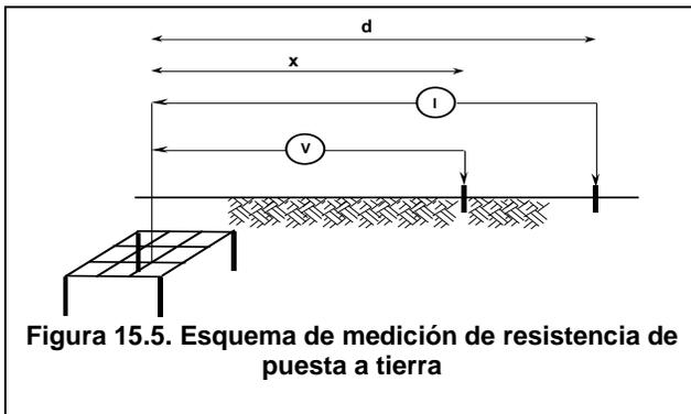
Figura 15.5. Esquema de medición de resistencia de puesta a tierra
