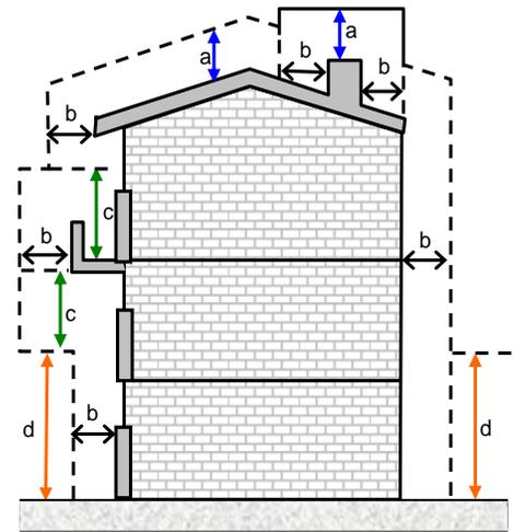
Figura 13.1. Distancias de seguridad en zonas con construcciones
