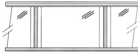
Figura K.4.3-2 — Soporte en dos lados — Una lámina de material para vidriado
