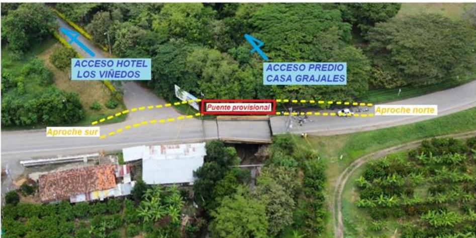
**Figura 2. Propuesta de Localización Puente Metálico PR88+200 Ruta 2302**
