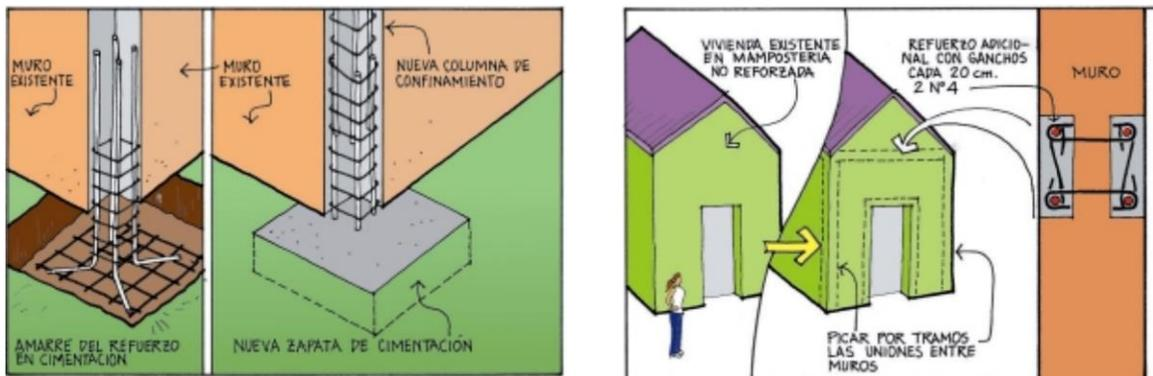
**Figura 17.** Esquemas de Procedimientos para Reforzamiento con Elementos Nuevos de Concreto
