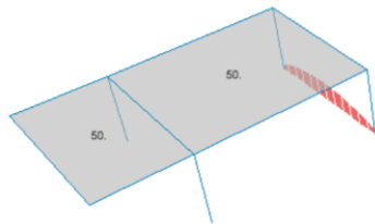
Figura 14. Cargas Muertas Cubierta aplicadas al Modelo Computacional
