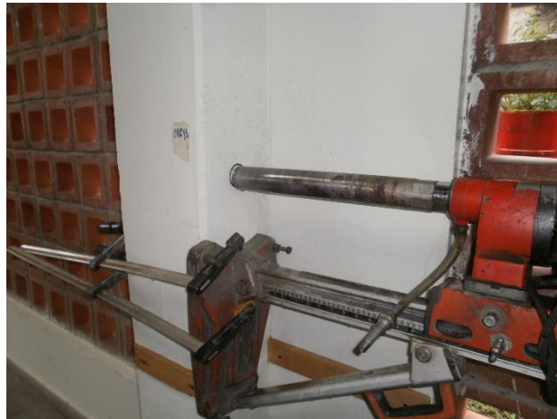
Figura 7. Registro fotográfico de Extracción de Núcleos
