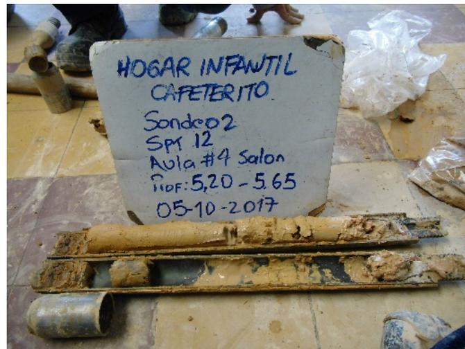
**Figura 32** Muestra de suelo correspondiente al sondeo 2, material arcillosos color amarillento saturado y de baja consistencia
