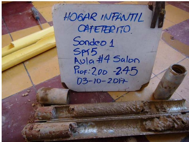
**Figura 29** Muestra de suelo correspondiente al sondeo 1 entre los 2.00m a 2.45m de profundidad donde se observa la alteración del comportamiento del suelo por la presencia del nivel freático.
