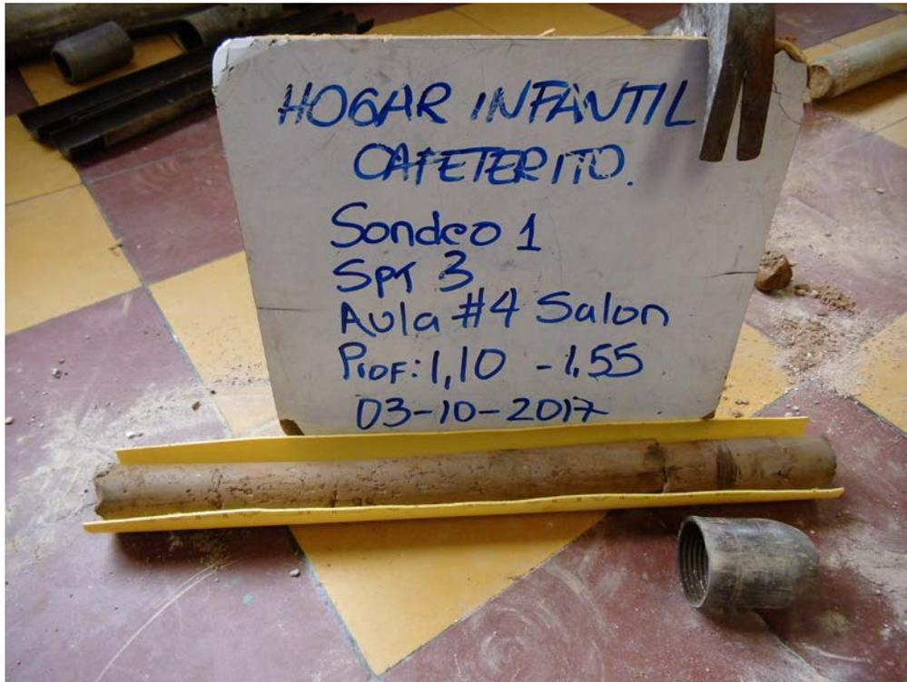
**Figura 28** Muestra de suelo en el sondeo N°1, suelo arcilloso entre 1.10m a 1.55m fr profundidad de consistencia blanda y húmeda de color amarillento con vetas naranjas y grises.
