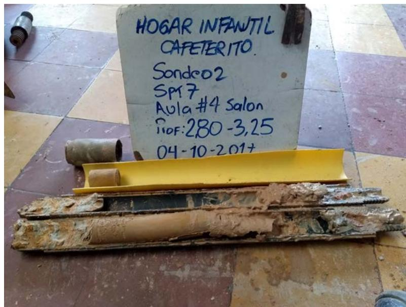
**Figura 30** Muestra de suelo correspondiente al sondeo 2 entre los 2.80m a 3.25m de profundidad donde se observa la alteración del comportamiento del suelo por la presencia del nivel freático.
