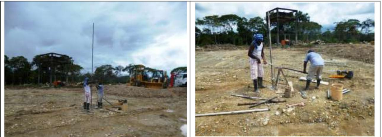
Figura 9. Sondeos con el barreno.
