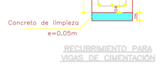
CONCRETO DE LIMPIEZA e=0.05m
