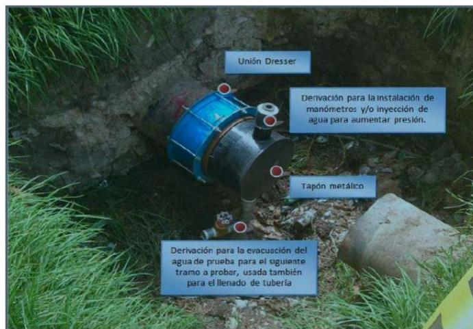
Figura 1. Esquema típico de Tapón de Prueba Hidráulica
