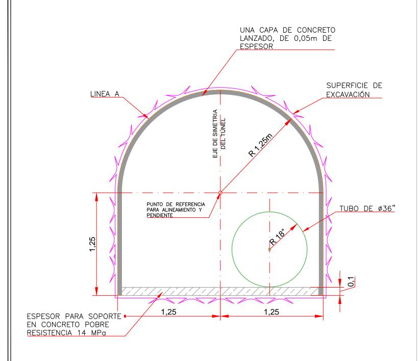
GEOMETRIA DE EXCAVACIÓN Y SOPORTE PARA ROCA METEORIZADA (TIPO III) ESC. 1:25
