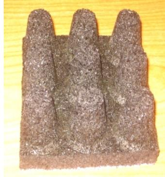
Es una superficie moldeada de fábrica que consiste e gomas neumáticas SBR de alta calidad y gránulos EPDM coloreados combinados en un poliuretano resistente al clima y al uso
