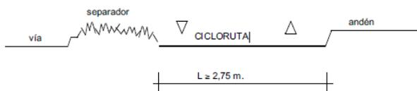
Con relación a las pendientes se debe tener en cuenta el esfuerzo requerido para escalarlas, requerimientos de seguridad en los descensos y la longitud de las pendientes no puede ser mayor al 3%.
