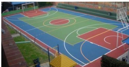
El campo de juego debe contar con una losa rectangular de concreto como mínimo de 32 m de largo por 19 m de ancho. En esta área debe albergar las canchas de baloncesto, microfútbol y voleibol (incluye los bujes donde se fijan los parales con su respectiva tapa de proyección cuando no esté en servicio), de acuerdo con la normativa.
