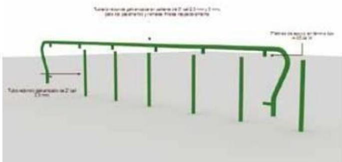
Elemento metálico elaborado en tubería redonda estructural, galvanizada en caliente, con diámetro nominal de 3" cal 2.5 mm y en cal 3 mm, para los remates curvados llamados corbates. Los parales estarán distanciados cada 1000 mm entre centros y serán fabricados, en tubo redondo galvanizado de 2" nominal cal 2.5 mm.
