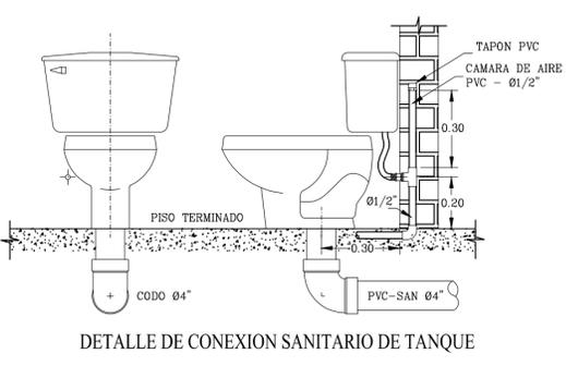
DETALLE DE CONEXION SANITARIO DE TANQUE
