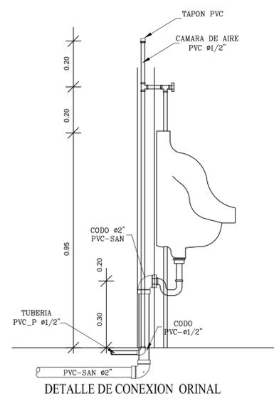
DETALLE DE CONEXION ORINAL
