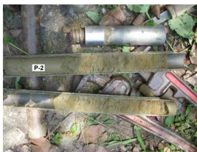
Fotografía No 5.1 Arenas limosas Capa B
