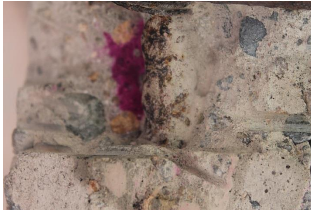
FOTO 5: Tipo de Agregado Grueso: Canto Rodado
