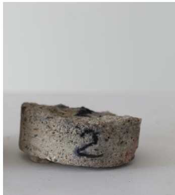
ILUSTRACIÓN 7-4. CARBONATACIÓN Y DEFECTOLOGÍA NÚCLEO NO 2 COLUMNA N° 2.
