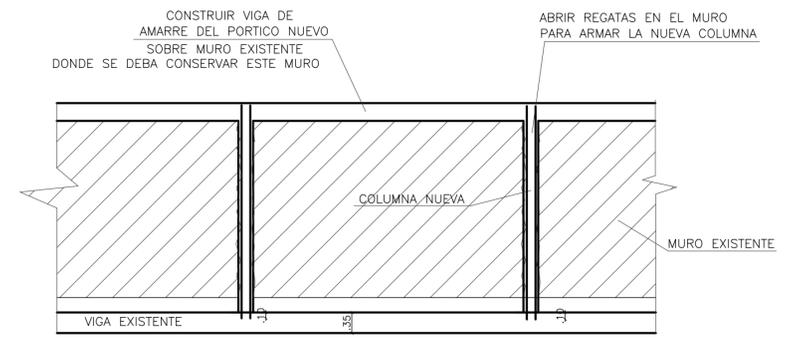
**CORTE TIPICO CONSTRUCTIVO PARA LA NUEVA ESTRUCTURA DONDE HAYA MUROS EXISTENTES Y ESTA VIGA EXISTENTE SE ENCUENTRE EN ESTRATO PORTANTE**
